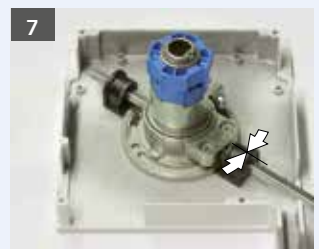
Das entgültige Ausrichten zum Antriebsstab erfolgt auf der Baustelle ohne Lösen der Klemmschraube.
