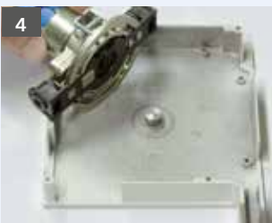
Kegelradgetriebe mit Schnellmontagesystem und Klemmblech auf den gekürzten Zapfen aufsetzen.
