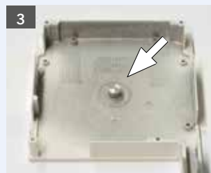
Ist der Zapfen auf das angegebene Maß gekürzt, kann mit dem Einbau des Getriebes fortgefahren werden.
