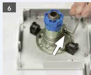
Die Schraube am Klemmblech (beidseitig schraubbar) mit einem 3 mm-Inbusschlüssel anziehen.
